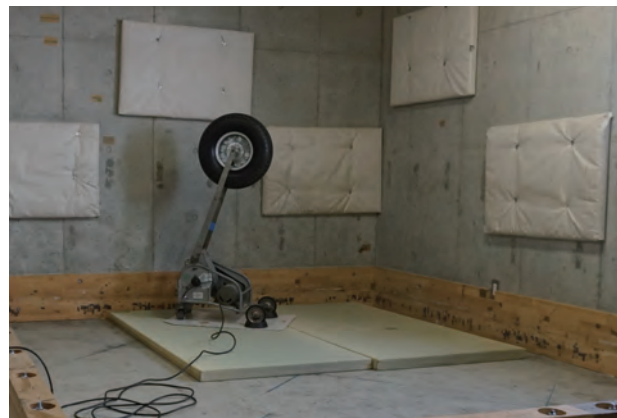
図5 タイヤ加振による畳床の測定
