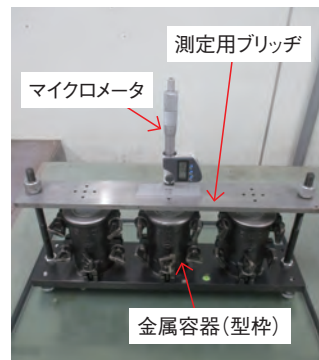
写真3 膨張収縮試験状況
