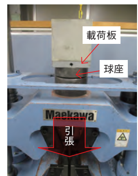
写真7 付着試験状況
