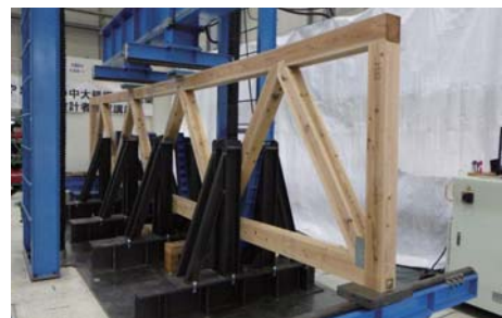
写真4 曲げ試験実施状況
