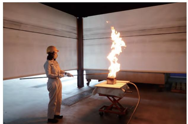
写真3 模型箱試験の校正の様子
