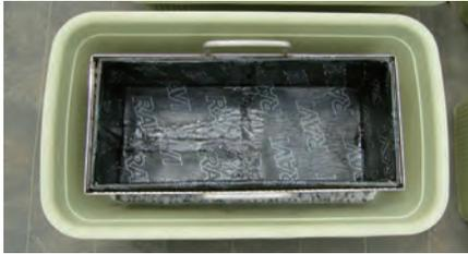
写真5 比較用防水層が施工された草本用コンテナ
