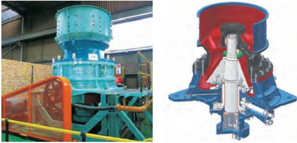
写真6 2次・3次破碎用油圧式コンクラッシャの例
