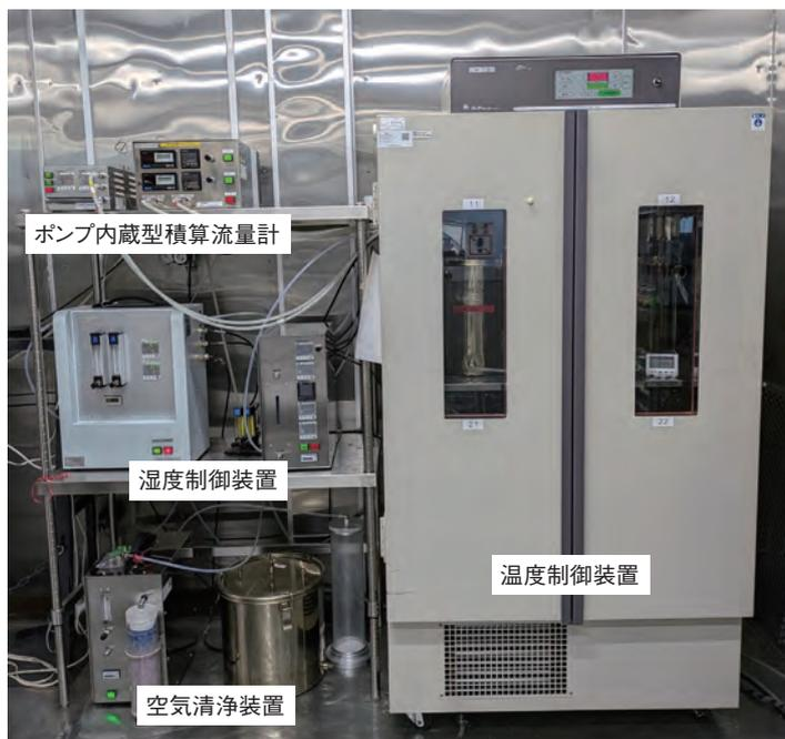
写真1 換気制御装置
