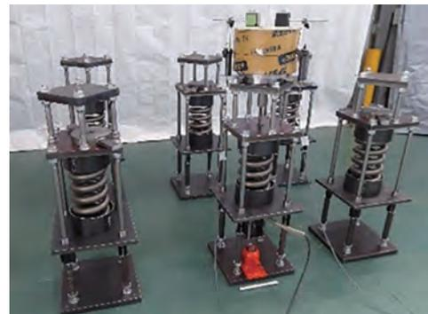
写真5 クリープ試験装置
