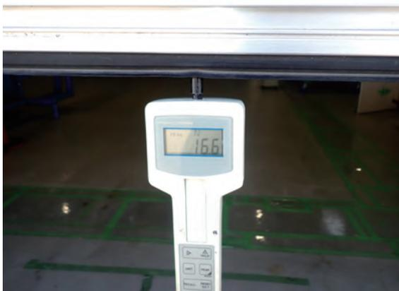
写真3 プッシュプルゲージによる開き力測定例
