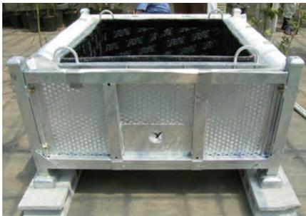
写真6 比較用防水層が施工された木本用コンテナ
