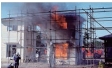
写真3 木造住宅の燃焼実験
