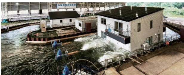
写真5 2階建て住宅の実大浸水実験
