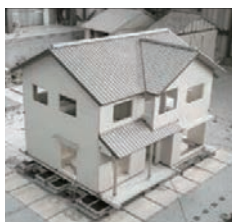
写真4 2階建て住宅の振動台実験
