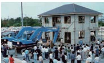
写真1 2階建て住宅の静加力実験
