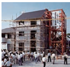
写真2 3階建て住宅の静加力実験
