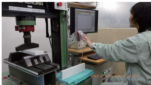
写真8 製品検査状況 (曲げ強さ試験)
