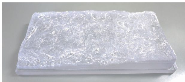
(a) 3D プリンタによりひび割れ部を再生したアクリル板
