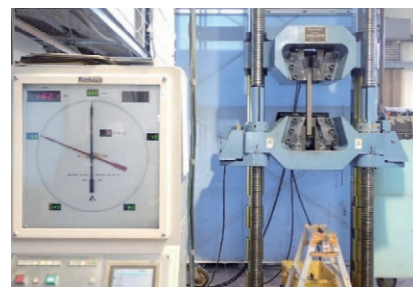
写真4 載荷状況の一例 (除荷直後)
