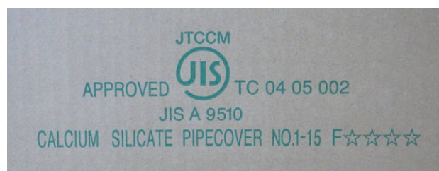
写真4 保温材梱包ケースへのJISマーク表示例
