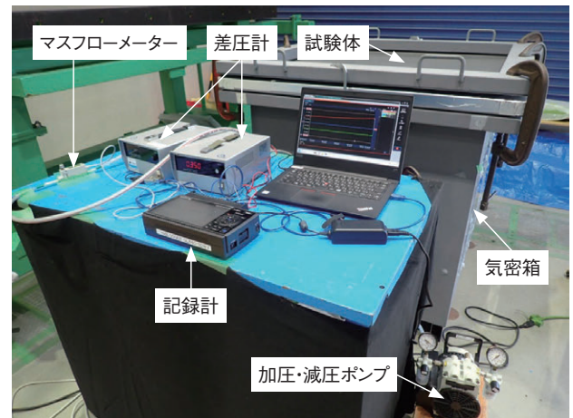
写真8 試験実施状況 (試験体3)
