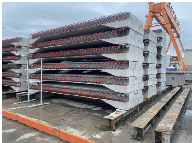
写真3 トンネル床版の一例
