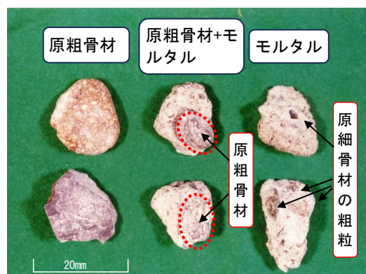
写真1 再生粗骨材の粒子の外観と粒子構成
