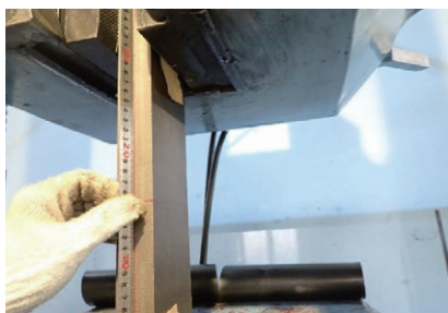
写真3 載荷状況の一例 (伸び測定)
