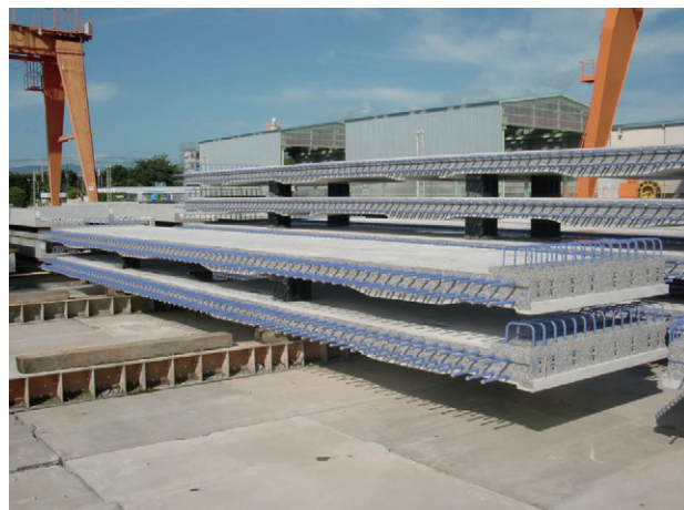
写真4 道路橋PC取替床版の一例
