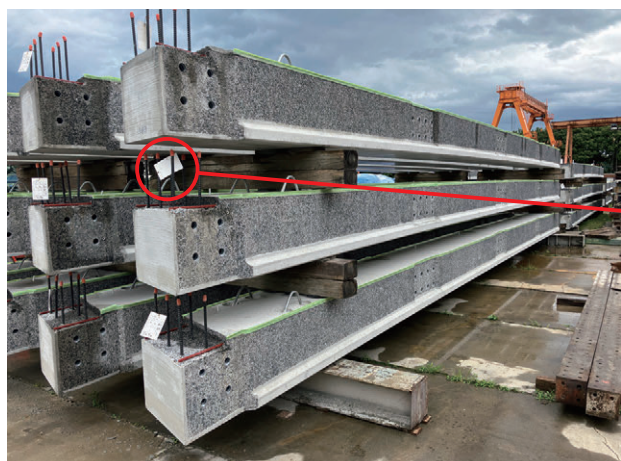
写真7 道路橋用橋げたの保管状況
