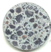
写真34 軽量コンクリート2種 (細・粗骨材とも人工軽量骨材)
