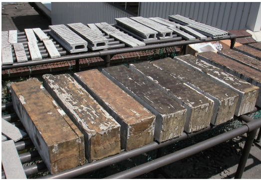
写真3 暴露試験に供した小型試験体と設置架台（北海道）
