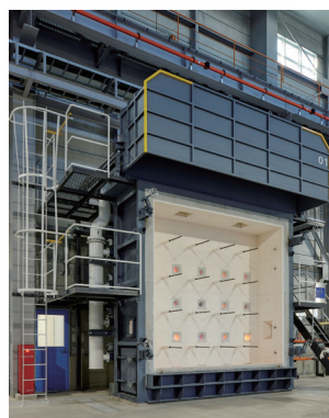
写真1 1号壁炉の外観
