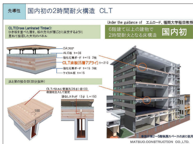
図2 松尾建設本社ビルの構造
