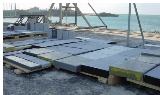
写真2 試験体の暴露試験の様子(沖縄)
