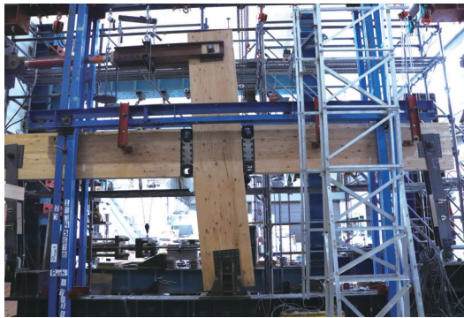
写真7 4階建て木造ビルを想定した十字型接合部のモーメント抵抗試験（大分大学）
