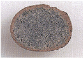
写真15 人工軽量骨材 （造粒型）の断面 （旧ALA協会HP）
