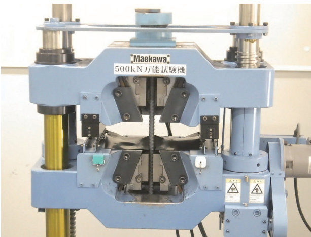
写真2 試験状況 (D22)
