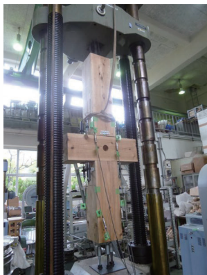
写真3 スギ製材大断面ブレース接合部の引張実験
