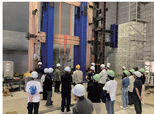
写真9 実大2層門型フレームの水平加力実験（東大柏キャンパス）
