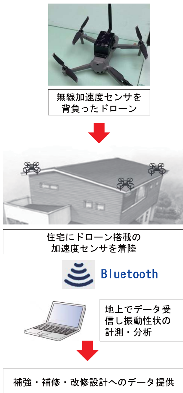
図7 ドローンを用いたセンサの設置と計測
