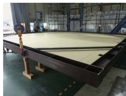
写真2 試験体の状況 (振れ止め材有り、90度位置)
