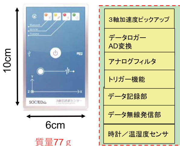
図5 Bluetooth通信の無線加速度センサ (2006年)
