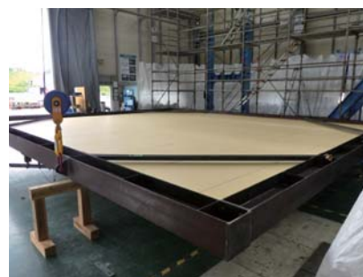
写真3 試験体の状況 (振れ止め材無し、90度位置)
