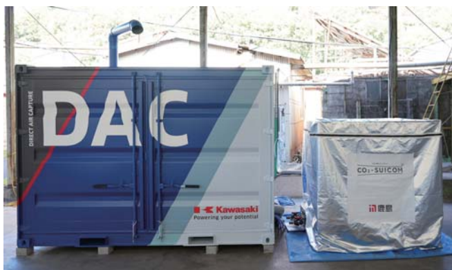
写真6 DAC装置（左）と炭酸化養生槽（右）
