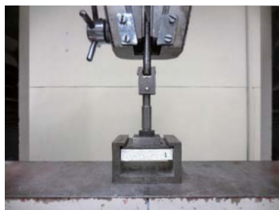
写真3 付着強さ試験状況
