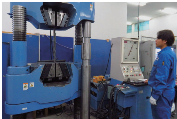
写真2 鉄筋の引張試験の様子
