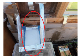
写真43 水位1.5m時の漏水量
