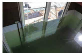
写真12 外壁部（入隅）の検証実験装置全体（注水時）
