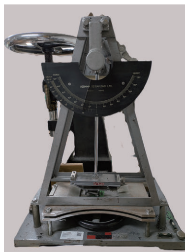
写真1 JIS A 1407の滑り性試験装置
