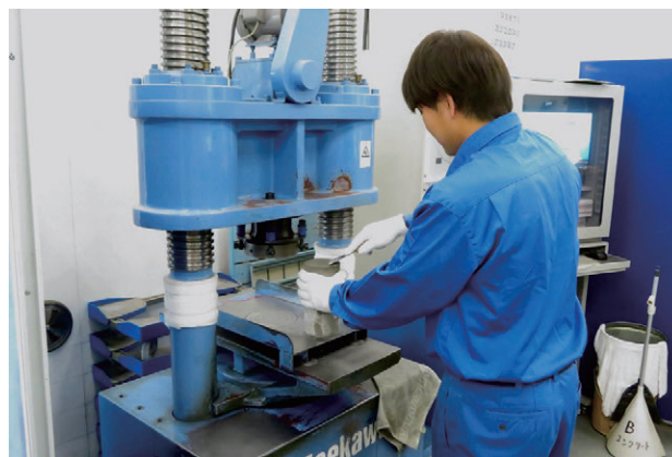
写真1 コンクリートの圧縮試験の様子
