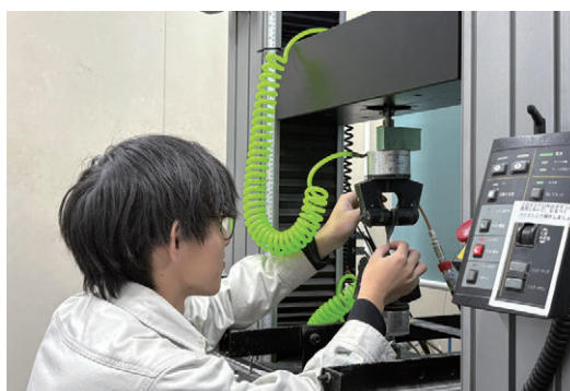
写真2 建築用塗膜防水材料の引張性能試験の様子
