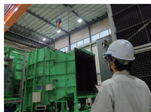
写真1 大型送風散水試験装置を使用した試験の様子
