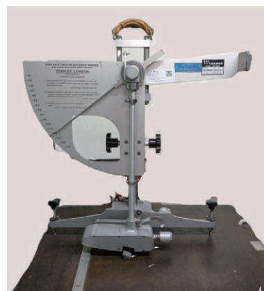
写真3 ASTM E303の滑り性試験装置
