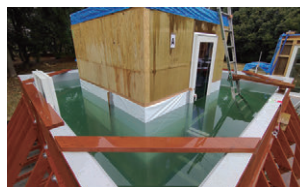
写真7 外壁部（出隅）の検証実験装置全体（注水時）
