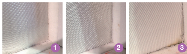
写真2 試験後の耐火クロス加熱側近影
