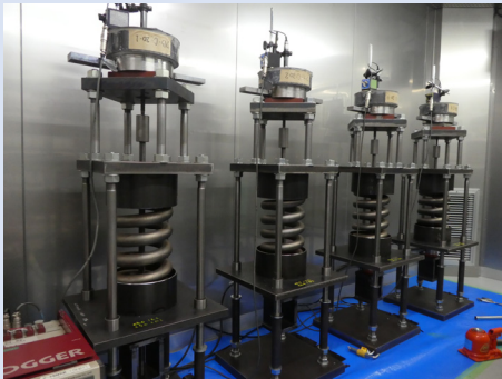
クリープ試験装置（左写真；20℃恒温恒湿槽、右写真；40℃恒温槽）
