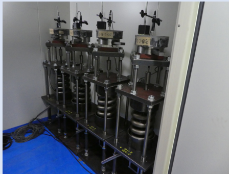
クリープ試験装置（左写真；20℃恒温恒湿槽、右写真；40℃恒温槽）
