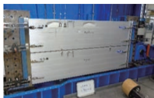
写真5 損傷状況 ・加撃点のパネルの変形
