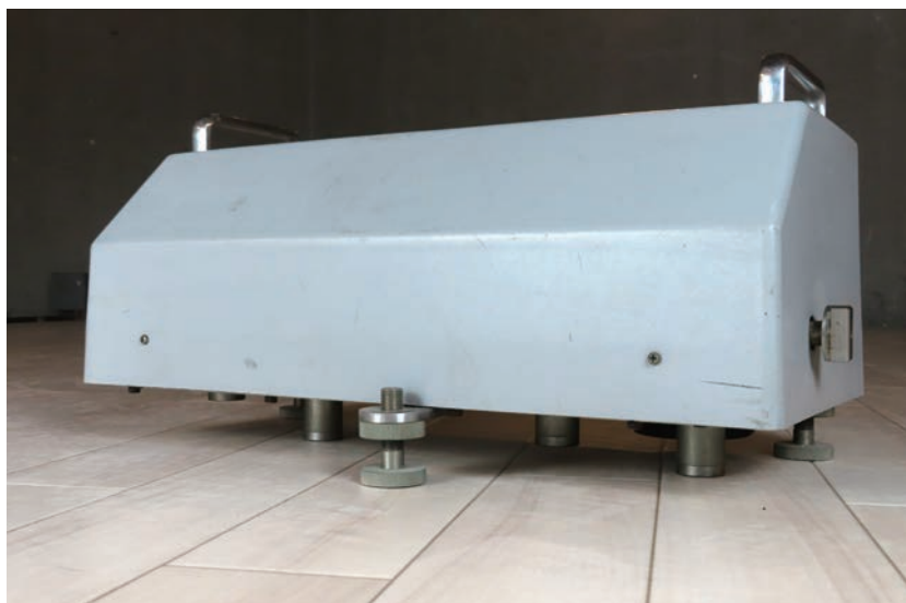
写真1 標準軽量衝撃源(タッピングマシン)
