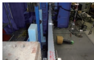
写真6 損傷状況 ・パネルの残留たわみ
