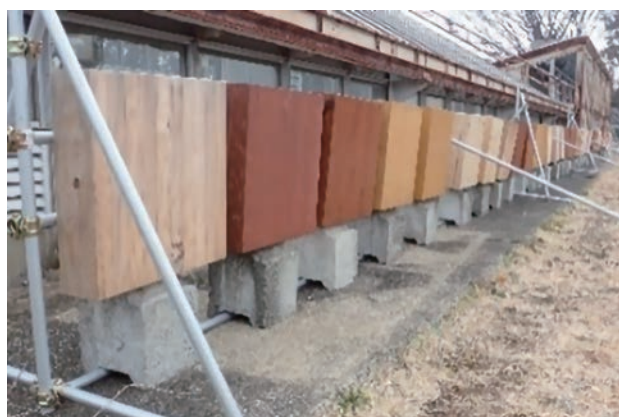
写真2 屋外暴露試験実施状況
